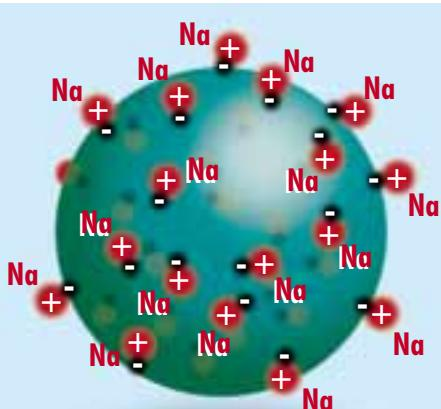
Chargée d'ions sodium, la résine les échange contre les ions calcium et magnésium, à l'origine de la dureté de l'eau.
